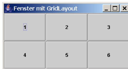
Abb. 19-5 : Fenster mit Grid-Layout
