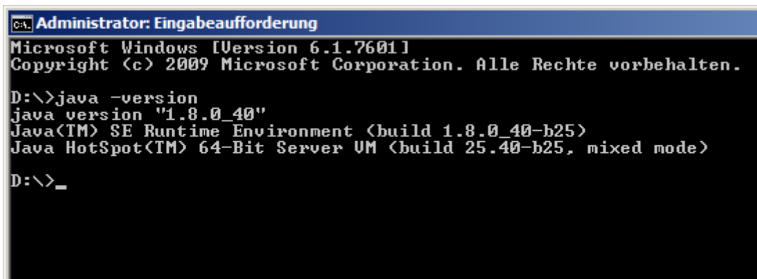
Abb. 4-1 : Installiertes JDK – Aufruf der JVM
